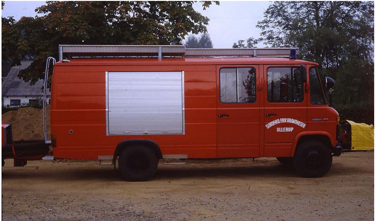
Ullerup friv. Brandværns nye store automobilsprøjte med 1000 liter vandtank og front pumpe. 1982.
