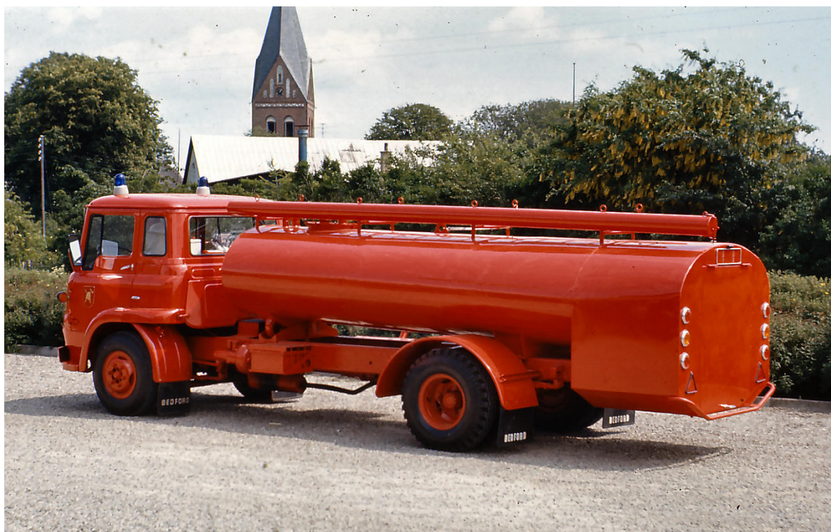
Vandtankvogn med 5000 liter vand og motorsprøjte. 1972.
