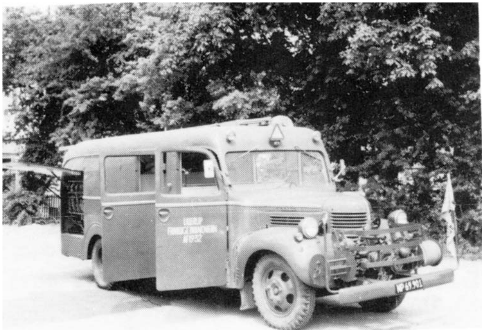
Værnets første automobilsprøjte fra 1956 med 1500 minut liters pumpe foran og indbygget vandtank.
